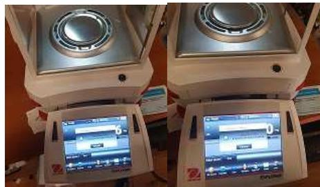
**Autocalibración de balanza con sensibilidad 0,01 mg.-**
