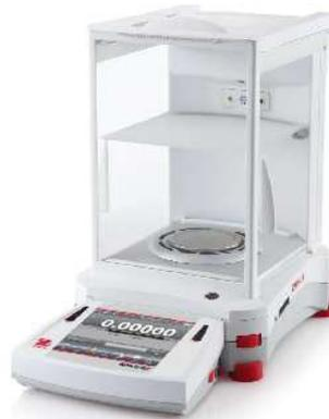
**Balanza utilizada en la gravimetría, sensibilidad 0,01 mg.-**
